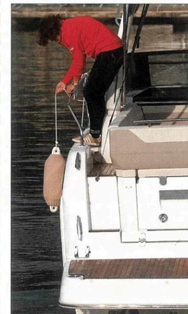
▼ Le passavant de bâbord n'est pas pratique à utiliser : la marche d'accès est trop haute et la sangle du bimini fixée en plein milieu est gênante.
