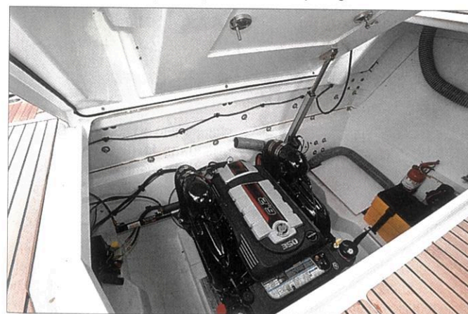
En version monomoteur, le bloc est à l'aise dans la cale. L'ouverture du capot se commande électriquement depuis le tableau de bord.
