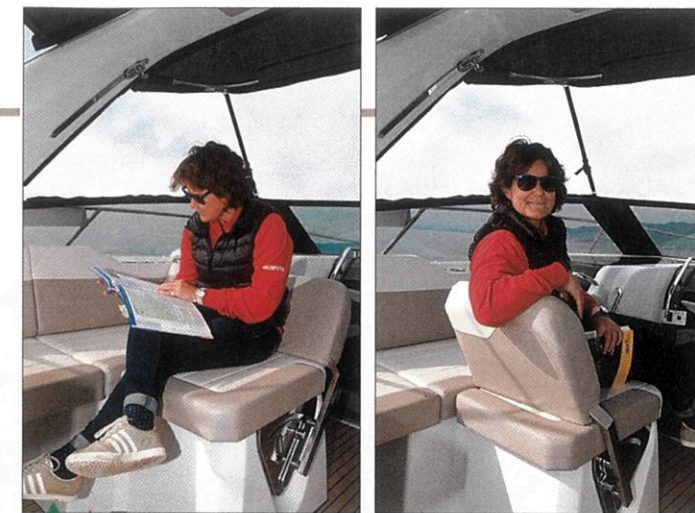
▲ Dans le cockpit, l'idée de cette assise vers l'avant ou vers l'arrière est bonne, mais l'inclinaison du dossier est à revoir.
