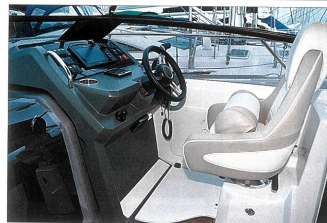
Le poste de barre assure une bonne position de conduite avec son siège à l'assise relevable et réglable et la planche pour surélever les petits gabarits.
