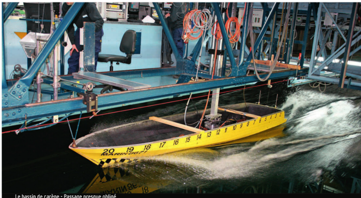
Le bassin de carène - Passage presque oblique
