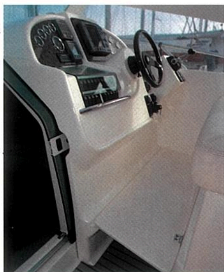
La tarima plegable permite gobernar de pie a patrones de cualquier envergadura.
