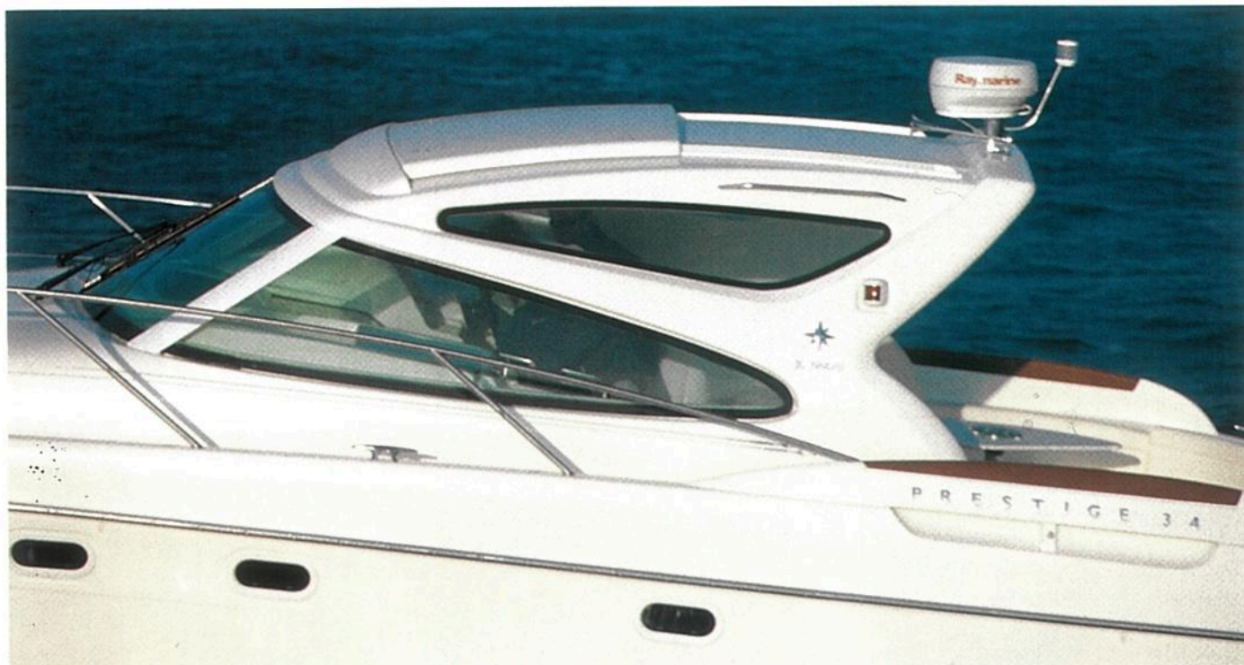
El diseño de la ventana lateral resta visibilidad en la versión dotada de hard-top. Para abrir el techo practicable basta pulsar un botón.
