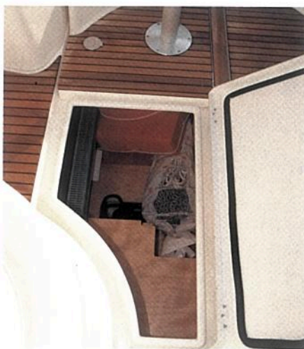
El espacio existente bajo el piso de la bañera también se utiliza para generar grandes cofres de estiba y almacenamiento.
