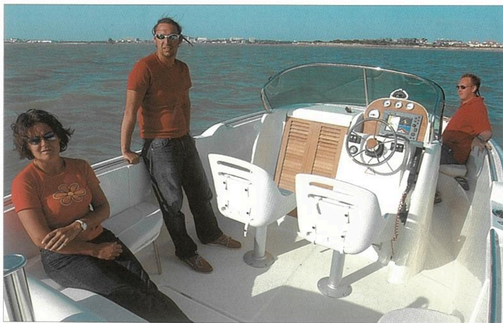
Derrière la console qui reçoit le poste de pilotage sur bâbord et la porte en teck à claire-voie de la petite cabine se trouvent deux sièges baquets réglables d'avant en arrière et pivotants.
