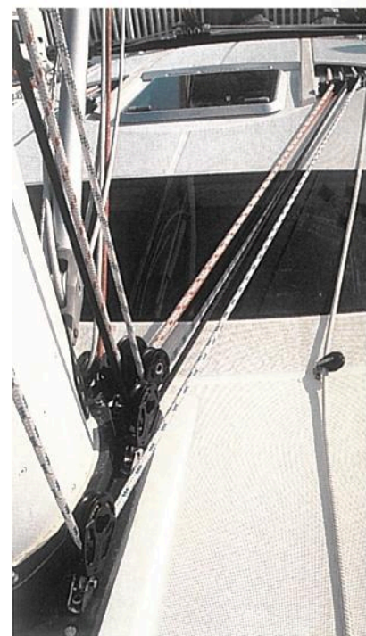
Los reenvíos bajo cubierta permiten disponer de otro solárium sobre la cabina.
