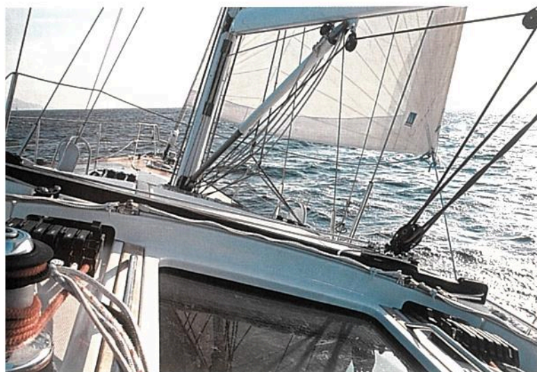
El riel de escota de la mayor está ubicado sobre el roof, quedando despejada la cubierta.
