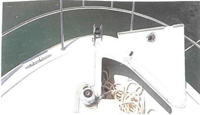
*El diseño de la maniobra deja a la vista el molinete -de serie- y la ranura por la cual fila la cadena del ancla.*
